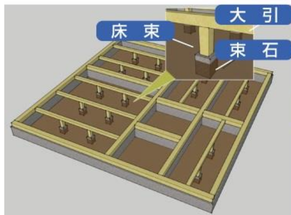
在来型工法（束石による大引支持）
